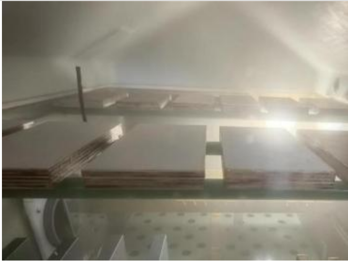
图 11-1 饰面胶合板（海洋板）耐盐雾测试
