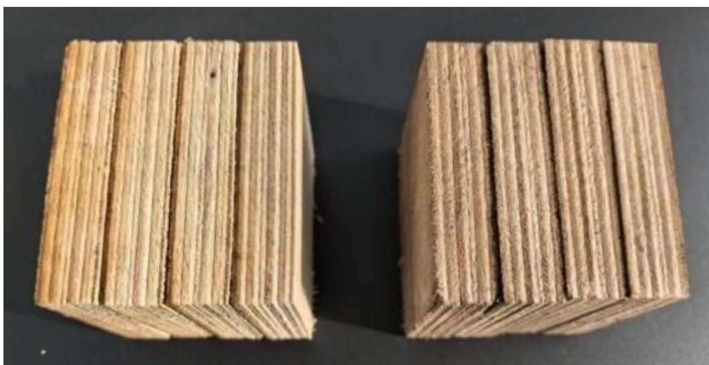
图 7 面层与基材浸渍剥离对比验证实验部分试件
