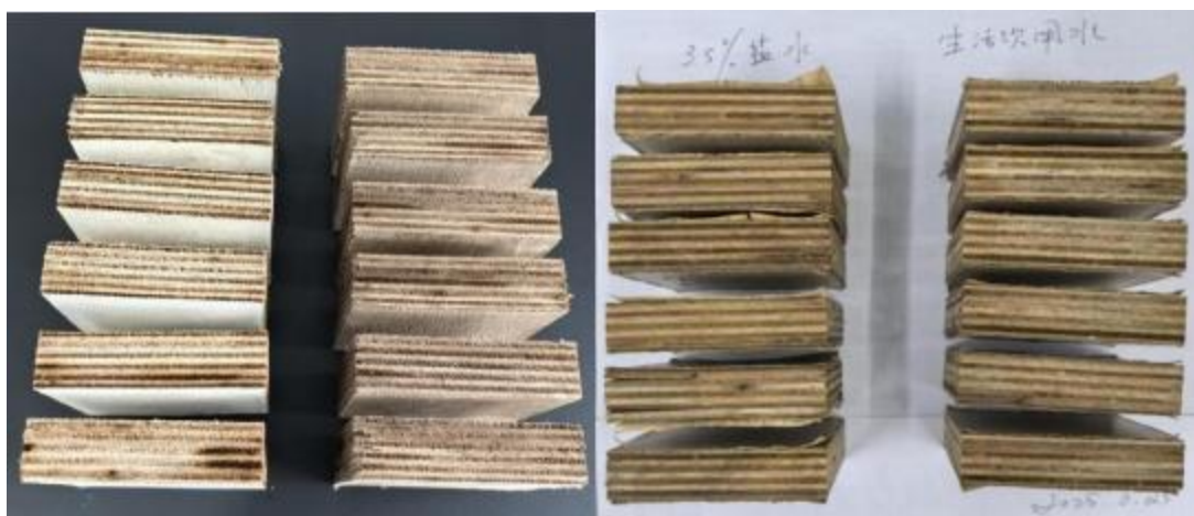
图 6 盐水与生活水浸渍剥离验证实验/试件结果
