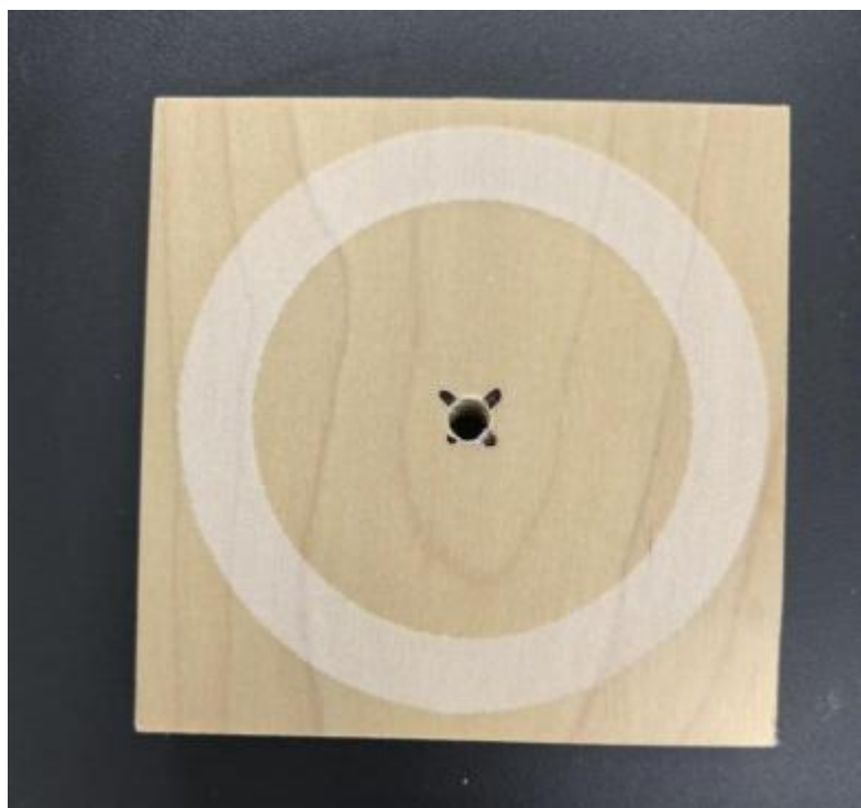
图 10 油漆饰面胶合板（海洋板）耐磨测试
