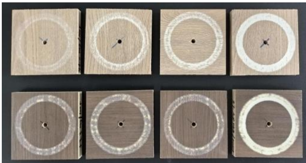
图 8 浸渍胶膜纸表面耐磨验证实验
