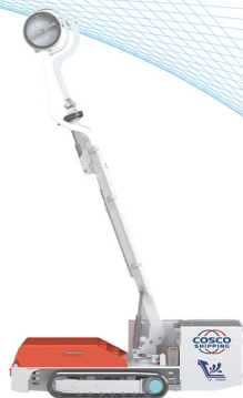
遥控坞底除锈机器人
