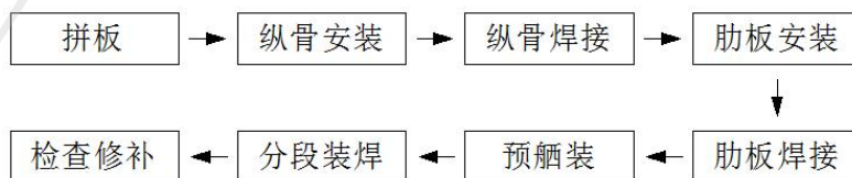
图1 平面分段数字化装焊工艺流程示意图
