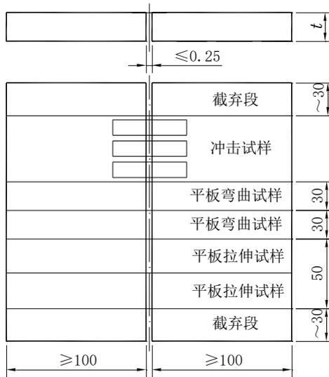
图A. 8 深熔对接焊试件的取样位置
